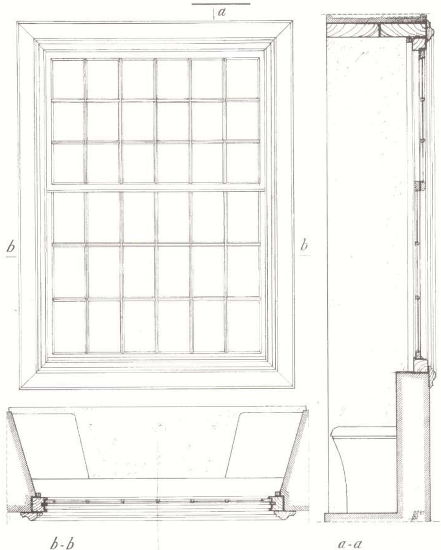
VENTANA DE GUILLOTINA. ALZADO, PLANTA Y SECCION PRINCIPAL.
