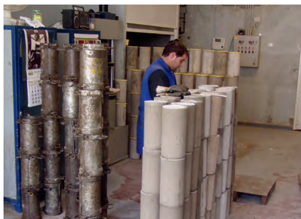
Figura 1: Llegada y desmoldeo de probetas de hormigón en un LCC.
