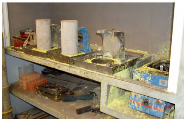
Figura 2: proceso de refrentado de probetas con mortero de azufre.
