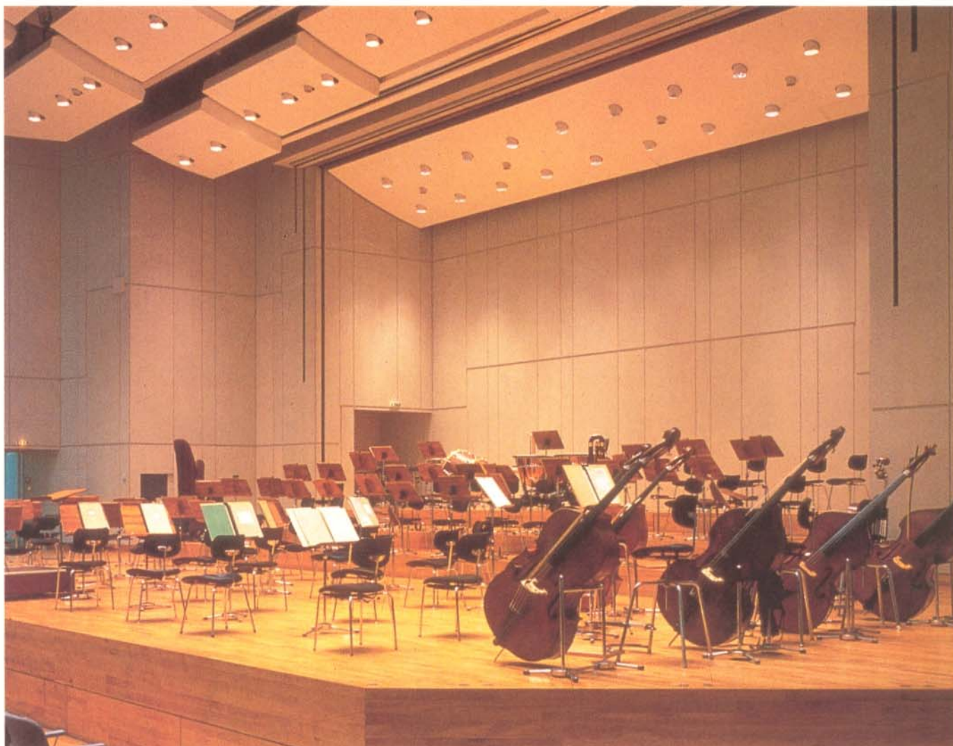
Las placas de yeso para techos perforados o ranurados ofrecen múltiples soluciones para acondicionar acústicamente los locales.
