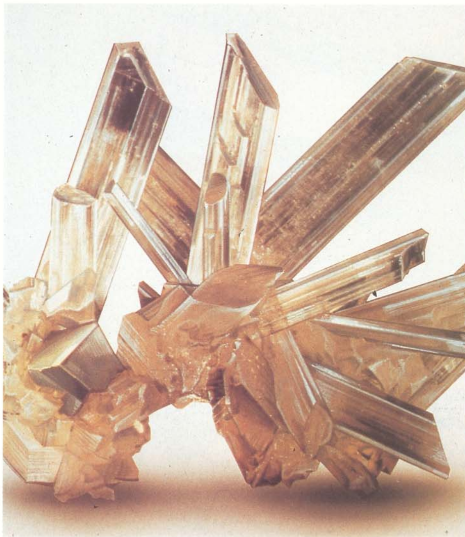
La materia prima es el cristal de yeso. Los tabiques Knauf con estructura metálica pueden recibir todo tipo de revestimientos.
