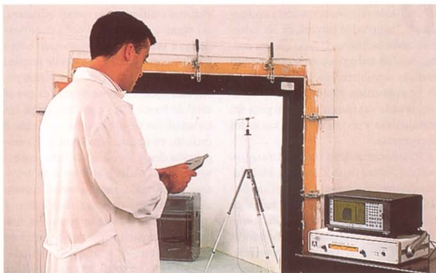
La absorción sonora se determina mediante ensayos en cámaras reverberantes.
