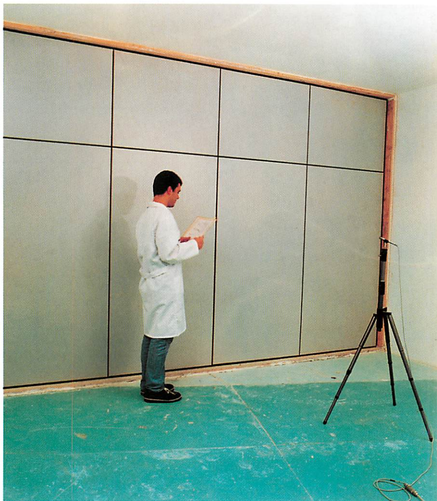
En las mediciones in situ se constatan múltiples caminos de transmisión.
